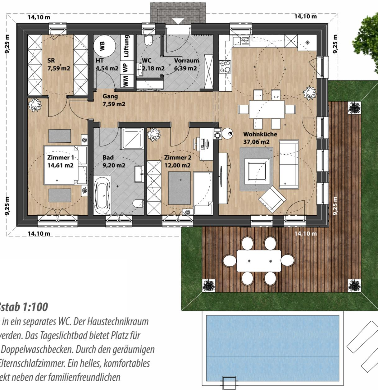
**Erdgeschoss | Grundriss im Maßstab 1:100**
